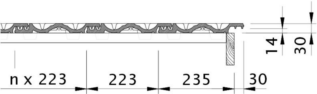
Zeichnung RATIO Ortgang rechts mit Ortgangblech und Flächenziegel OFR
