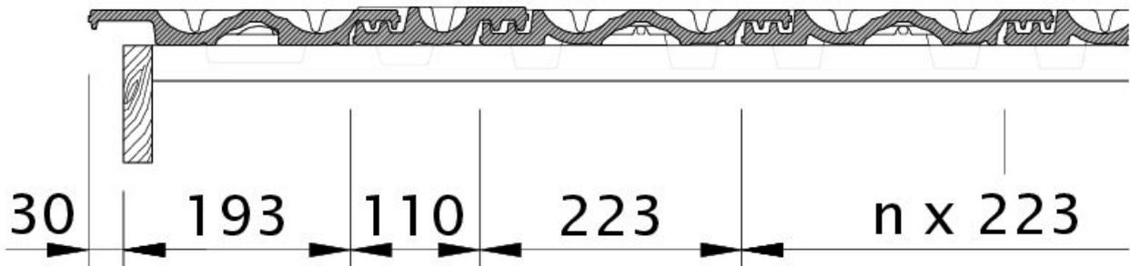
Zeichnung RATIO Ortgang links mit Ortgangblech und Doppelwulst ODL
