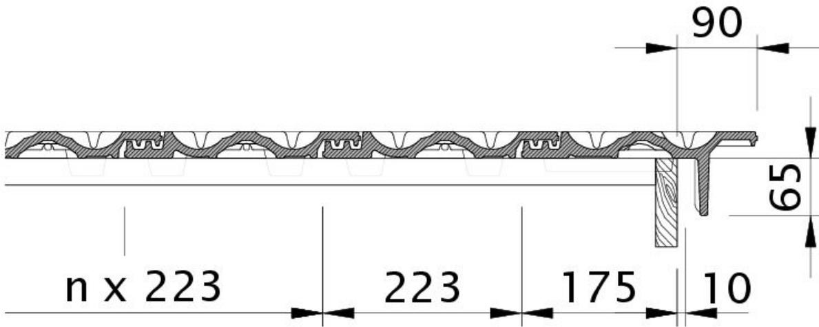
Zeichnung RATIO Ortgangziegel rechts mit Ortgangbrett OBR
